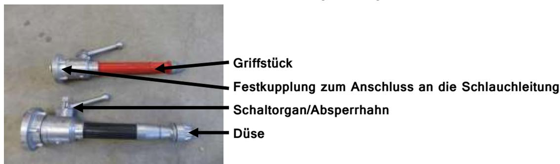
Bei (Wasser-)Strahlrohren kommt es durch eine Querschnittsverringeringung zu einer Erhöhung der Fließgeschwindigkeit des hindurchfließenden Löschmittels. Dies bewirkt, dass das Löschmittel beim Verlassen des Strahlrohres einen höheren dynamischen Druck hat und dadurch die entsprechenden Wurfweiten des Löschmittelstrahls erzeugt werden.
