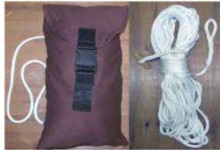
Die Feuerwehrleine (30m lang) dient als Rettungs-, Sicherungs- und Signalleine sowie sonstigen unmittelbar mit dem Einsatz in Zusammenhang stehenden Zwecken.
