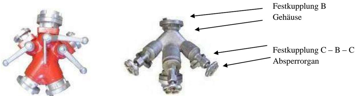
Ein Übergangsstück ermöglicht die Vornahme von insgesamt drei C-Strahlrohren. Es werden Niederschraubventile oder Kugelhähne verwendet. Bei Verteiler mit Kugelhähnen muss aus der Stellung des Hebels die Schalterstellung zu ersehen sein, ob der Abgang offen oder geschlossen ist. Steht der Schalthebel quer zur Strömungsrichtung, befindet es sich in geschlossener Stellung. Um bei Kugelhähnen schädliche Druckstöße zu vermeiden, sind diese langsam zu öffnen und zu schließen.
