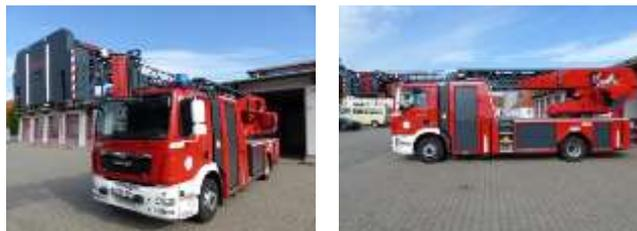
Die Hubarbeitsbühne ist ein Feuerwehrfahrzeug bestehend aus einem Arbeitskorb und einer hydraulischen Hubeinrichtung.
