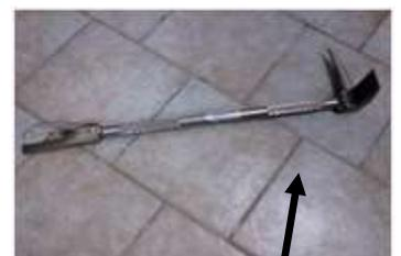
Im Laufe der Zeit entwickelten sich Universal-Brechwerkzeuge. Ein Beispiel ist das Halligan Tool. Es hat eine Metallschneideklaue, einen Dorn und einen flachen Fuß zum Hebeln. Man kann es als Brechwerkzeug oder zum Schaffen von Öffnungen im Blech nutzen. Diese Öffnungen können mit dem am oberen Ende des Tools befindlichen Blechaufreißer vergrößert werden.
