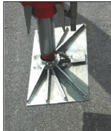
**Bild 29: Stützteller aus Stahl**
