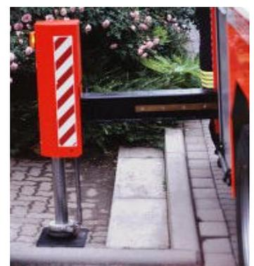
**Bild 23: Waagrecht-Senkrecht-Abstützung der Drehleiter**
