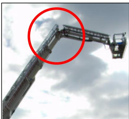
Bild 30: Gefährlicher Überstieg im Gelenkbereich
