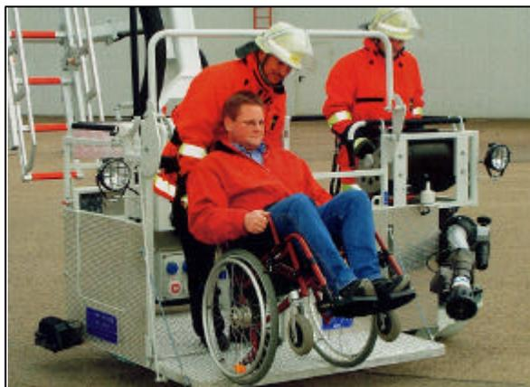
**Bild 11: Zugang über Vorbauplattform:**
