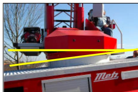
Bild 26: Niveaueingleich der Drehleiter im Drehturm
