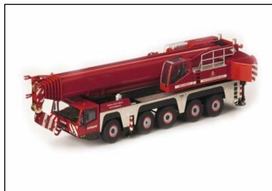
**Bild 6: Teleskopkran mit Teleskopausleger in Fahrstellung**
