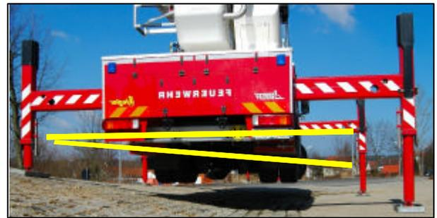
Bild 27: Niveaueingleich durch Abstützung beim Teleskopgelenkmast
