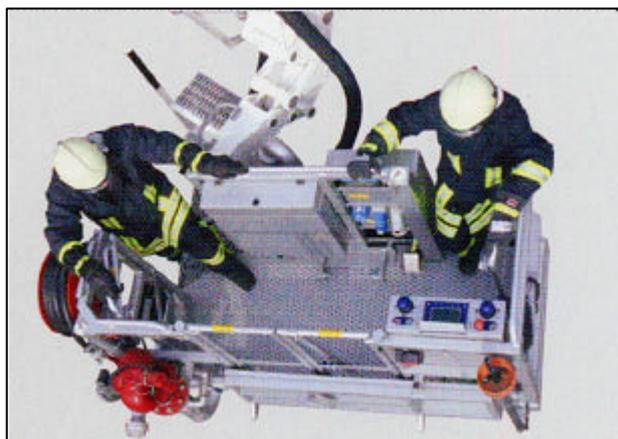
**Bild 10: Arbeitsbühne eines Teleskopgelenkmasts**
