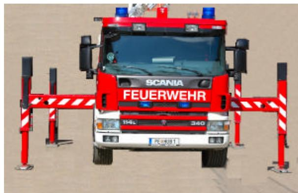
Bild 25: Wuchtige Stützen des Teleskopgelenkmasts
